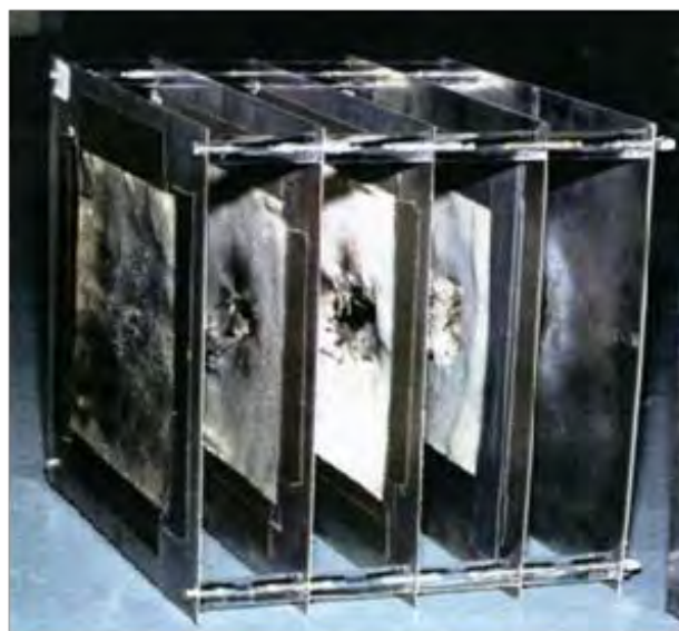
Figure 5 : Blindage protecteur contre les impacts et petits débris (NASA)
