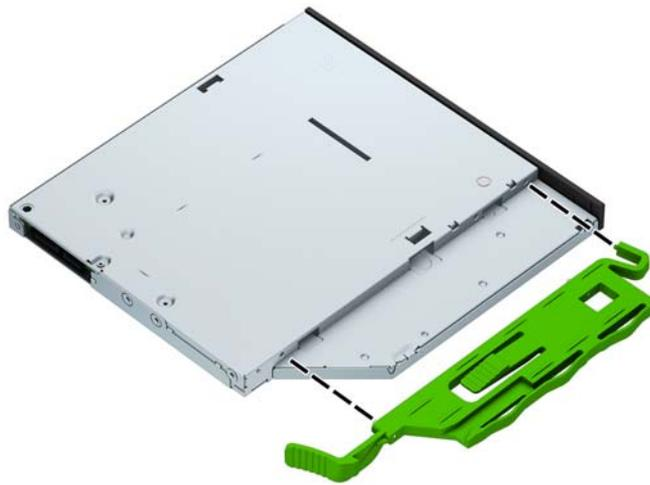
9. Insérez le lecteur optique à travers la face avant et faites-le glisser complètement à l'intérieur du compartiment (1) de sorte que le loquet situé à l'arrière du lecteur s'emboîte (2).
