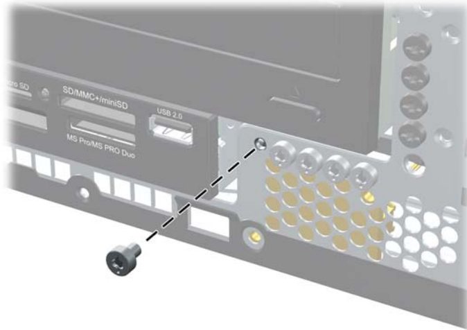
Figure 4-50 Réinstallation de la vis de sécurité du cache avant
