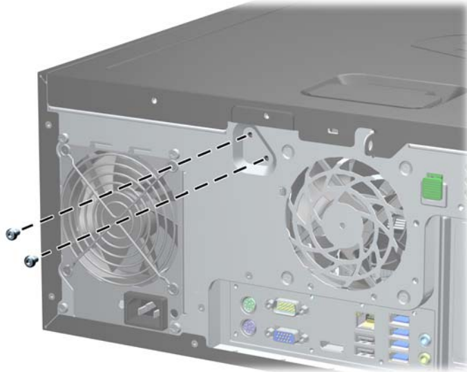
Figure C-2 Retrait des vis du verrou du capot intelligent de la microtour
