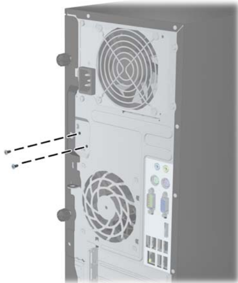
Figure C-2 Retrait des vis du verrou du capot intelligent de la microtour
