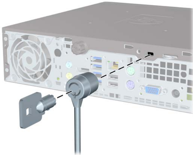
Figure 5-25 Installation d'un câble avec un cache de port
