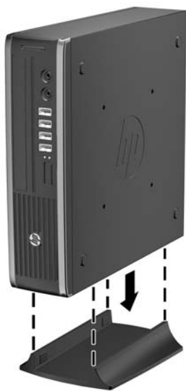
Figure 5-7 Placement de l'ordinateur sur le socle
