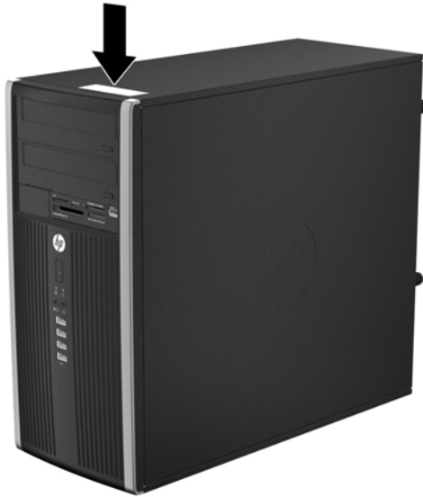
Figure 1-16 Emplacement du numéro de série et de l'ID de produit de l'ordinateur compact
