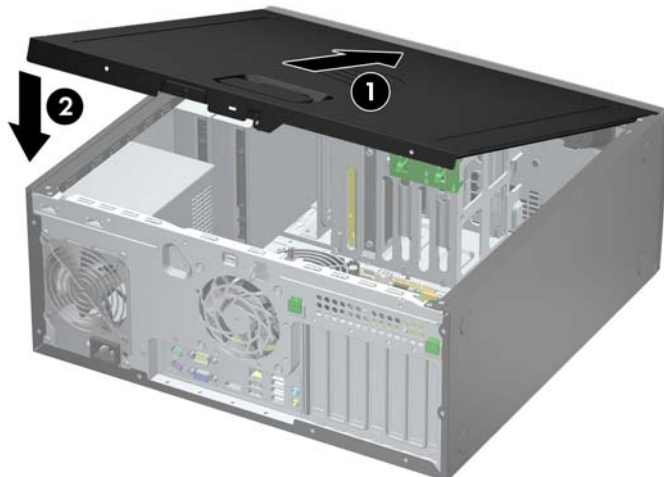
Figure 2-2 Remise en position du panneau d'accès de l'ordinateur
